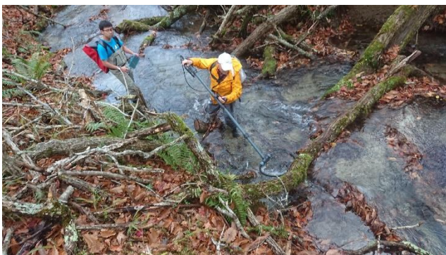
写真2 持ち運び式の PIT タグアンテナを用いた魚類の居場所調査
